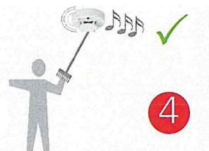
Нажмите и удерживайте прибл. **5 секунд** кнопку на корпусе извещателя. После того как прозвучит **тестовый сигнал** (1 сек. вкл. / 1 сек. выкл.), **дымовой пожарный извещатель готов** к работе. Если сигнал не прозвучит, как можно быстрее позвоните по телефону **горячей линии:** **08002 001264**
